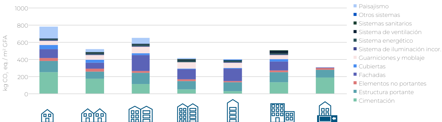
Figura 18 - Casos sintéticos. Contribución al PCG de los elementos según Level(s) en Kg CO2eq./m2 Sup. construida (GFA), arquetipos modales no sísmicos.
