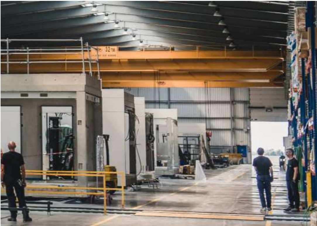
Cadena de montaje de viviendas industrializadas de Aedas Homes. La construcción inmobiliaria busca la sustitución de obreros por robots. Alfonso Simón Ruiz, El País Economía 2018.
